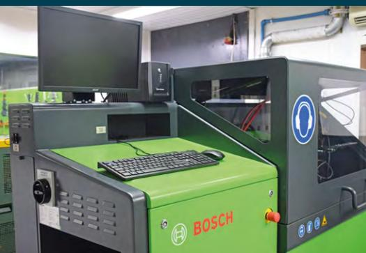
**BOSCH 708** A mais recente e evoluída da marca, com a função de teste Common Rail (Injetores e Bombas Injetoras), que equipam a maioria dos veículos.
