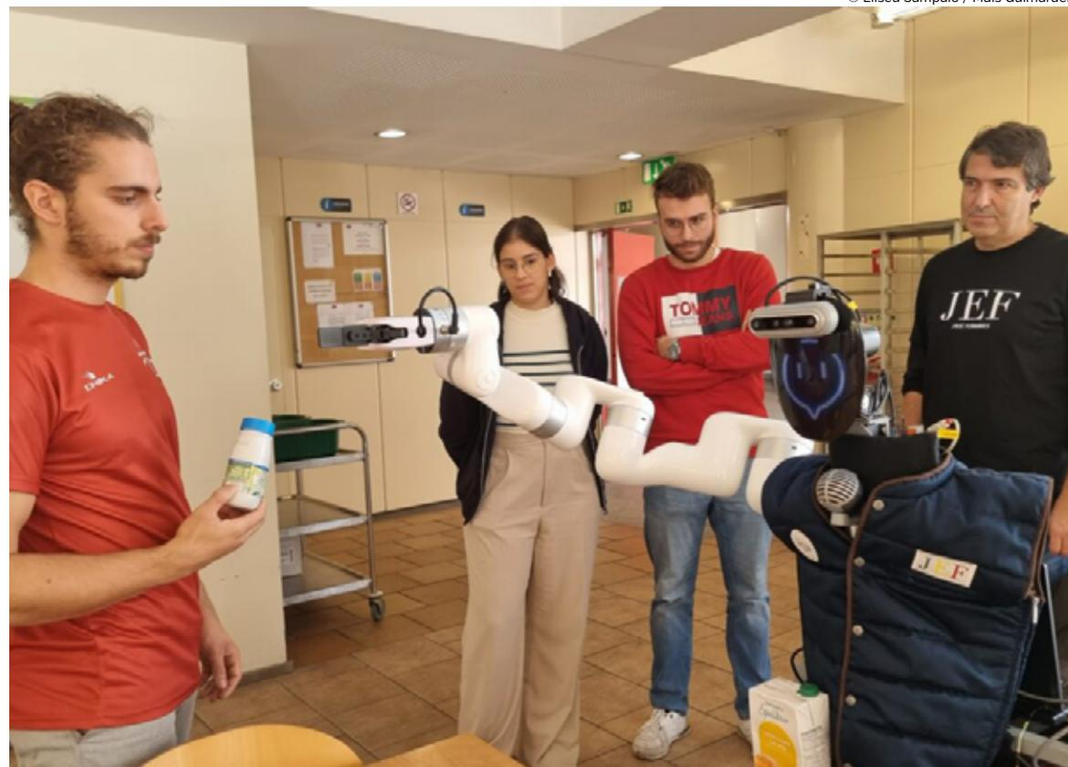
O CHARMIE é um robô móvel e autónomo que possui um braço manipulador e colunas, sendo capaz de realizar tarefas e prestar serviços em ambientes domésticos, hospitalares e interagir com o ser humano. O robô permite apoiar idosos ou pessoas com mobilidade reduzida a realizar tarefas básicas.
